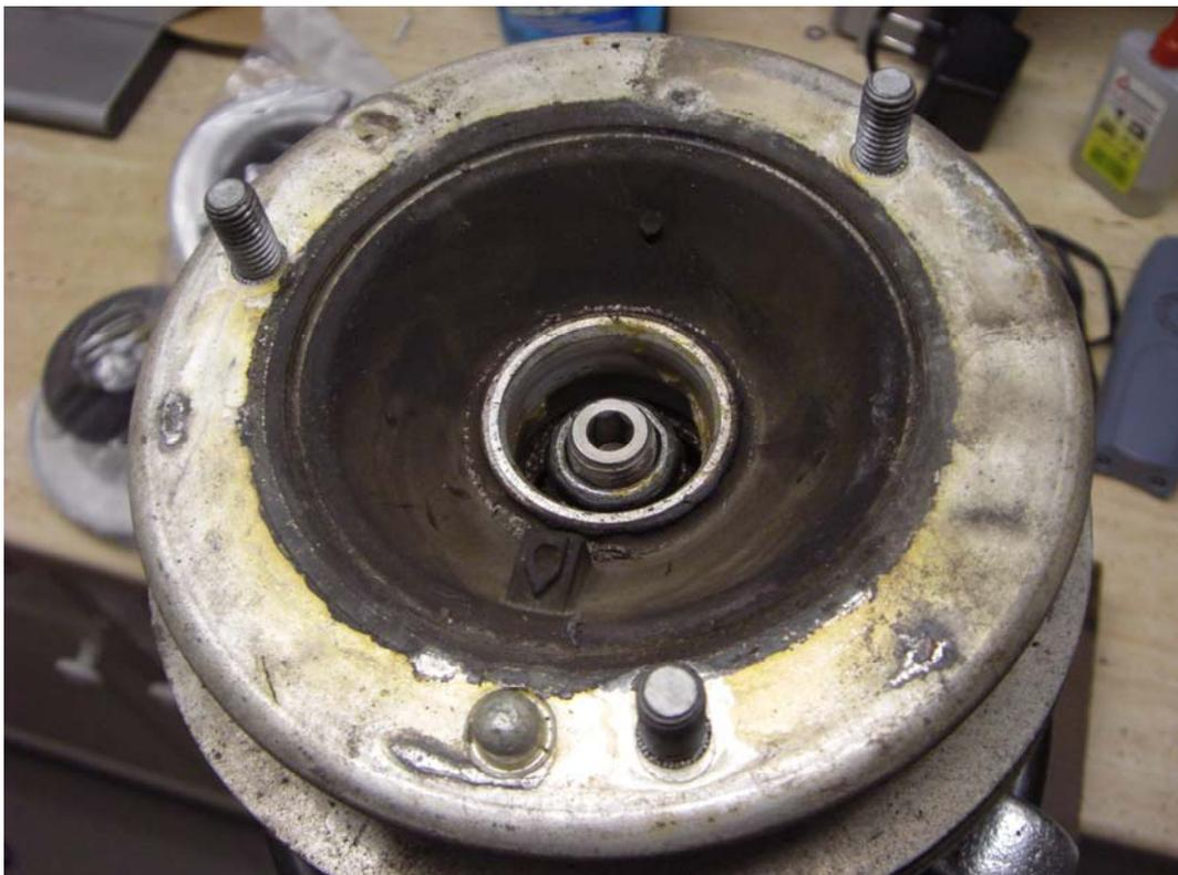
11. Wenn man nun die Mutter von der Kolbenstange abdrehen will, braucht man eine geeignete Nuss (bei mir war es Größe 21) oder einen Ringschlüssel. Zusätzlich benötigt man einen Imbusschlüssel, mit dem man (in der Mitte) an der Kolbenstange kontern kann.
