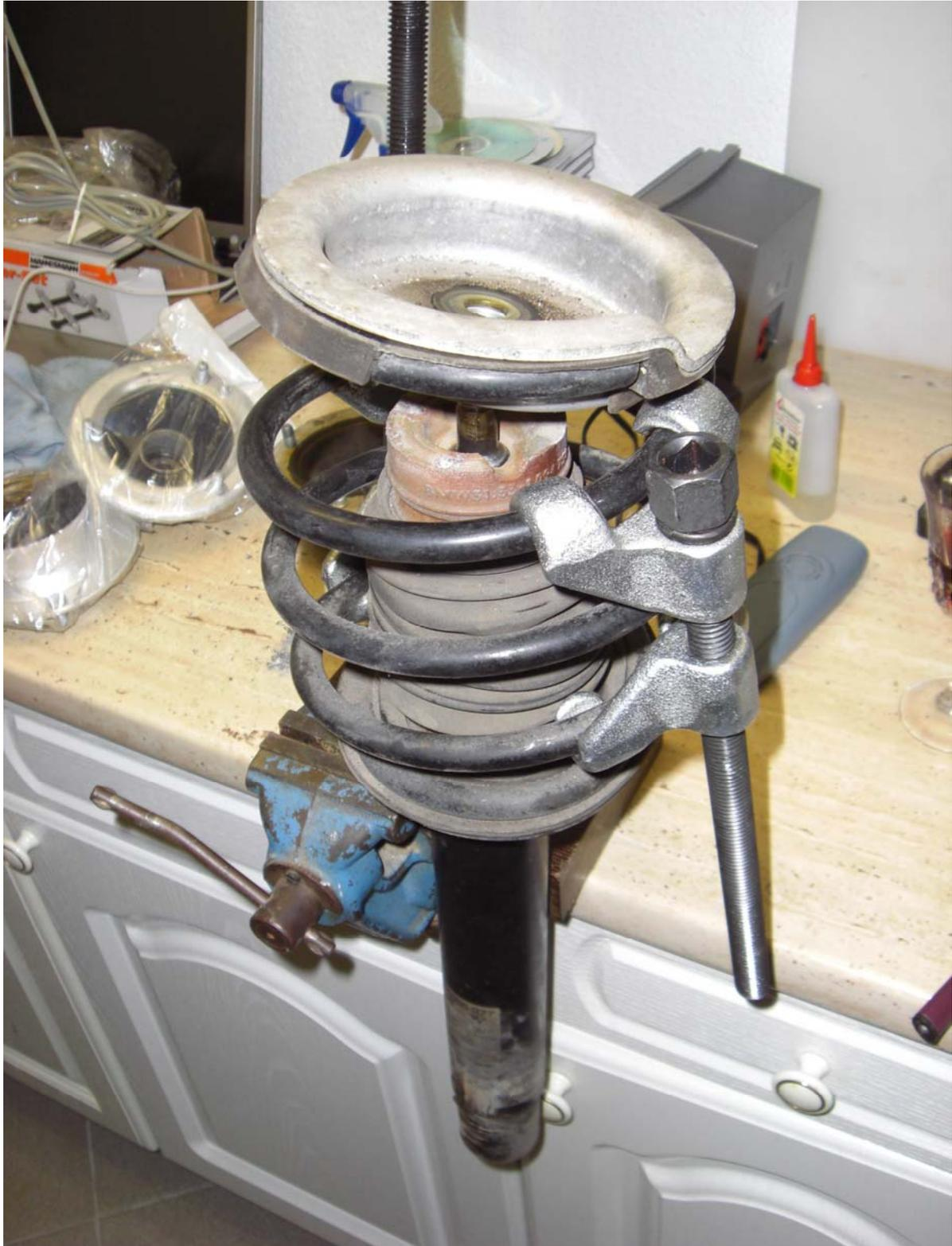
13. Nun nimmt man die gespannte Feder samt Gummiunterlage (auf Beschädigung prüfen!) vom alten Stoßdämpfer ab und baut alles wieder in richtiger Reihenfolge auf den neuen Stoßdämpfer auf. Schraubt nun das Stützlager wieder an der Kolbenstange fest. Zieht die Mutter richtig fest an, aber „knallt“ sie **nicht extrem** fest (Drehmoment laut BMW ist hier: 64Nm).
