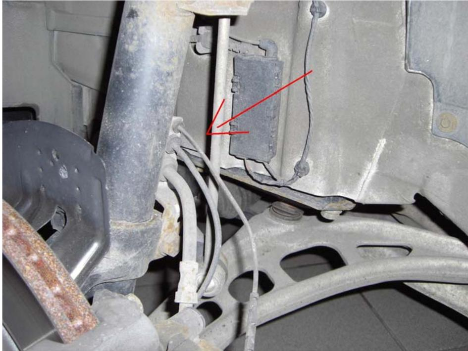
3. Koppelstange (auch Pendelstütze genannt) demontieren. Dazu einfach die Muttern am Dämpfer bzw. Stabilisator lösen. Falls sich der Gewindebolzen mit dreht, dann einfach hinten mit einem 17er Gabelschlüssel dagegen halten.
