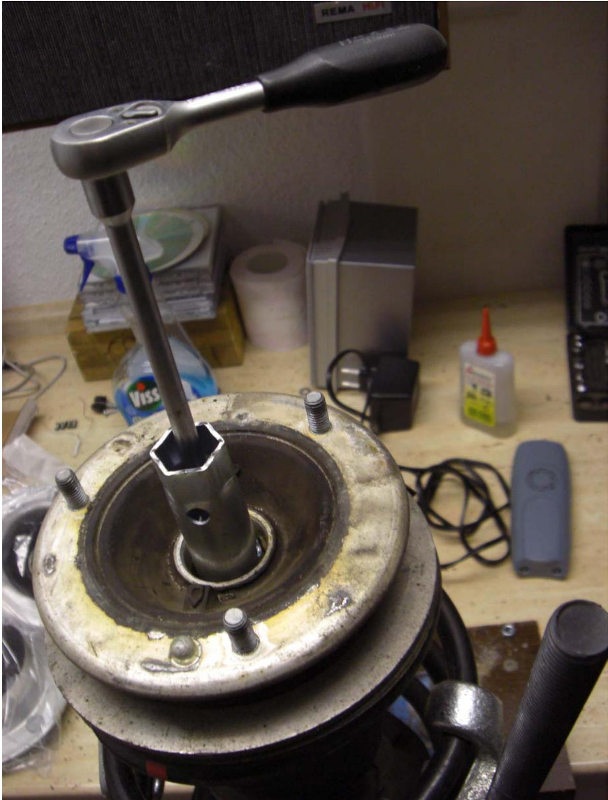
12. Ist die Mutter gelöst, kann man das Stützlager abnehmen. Ich habe das alte Lager gegen ein neues getauscht, aber es ist nicht zwingend erforderlich. Das muss jeder selbst entscheiden. Unter dem Lager befindet sich noch eine Metall-Staubschutzscheibe und eine Distanzscheibe. Diese kann man wieder verwenden...einfach reinigen und neu einfetten.
