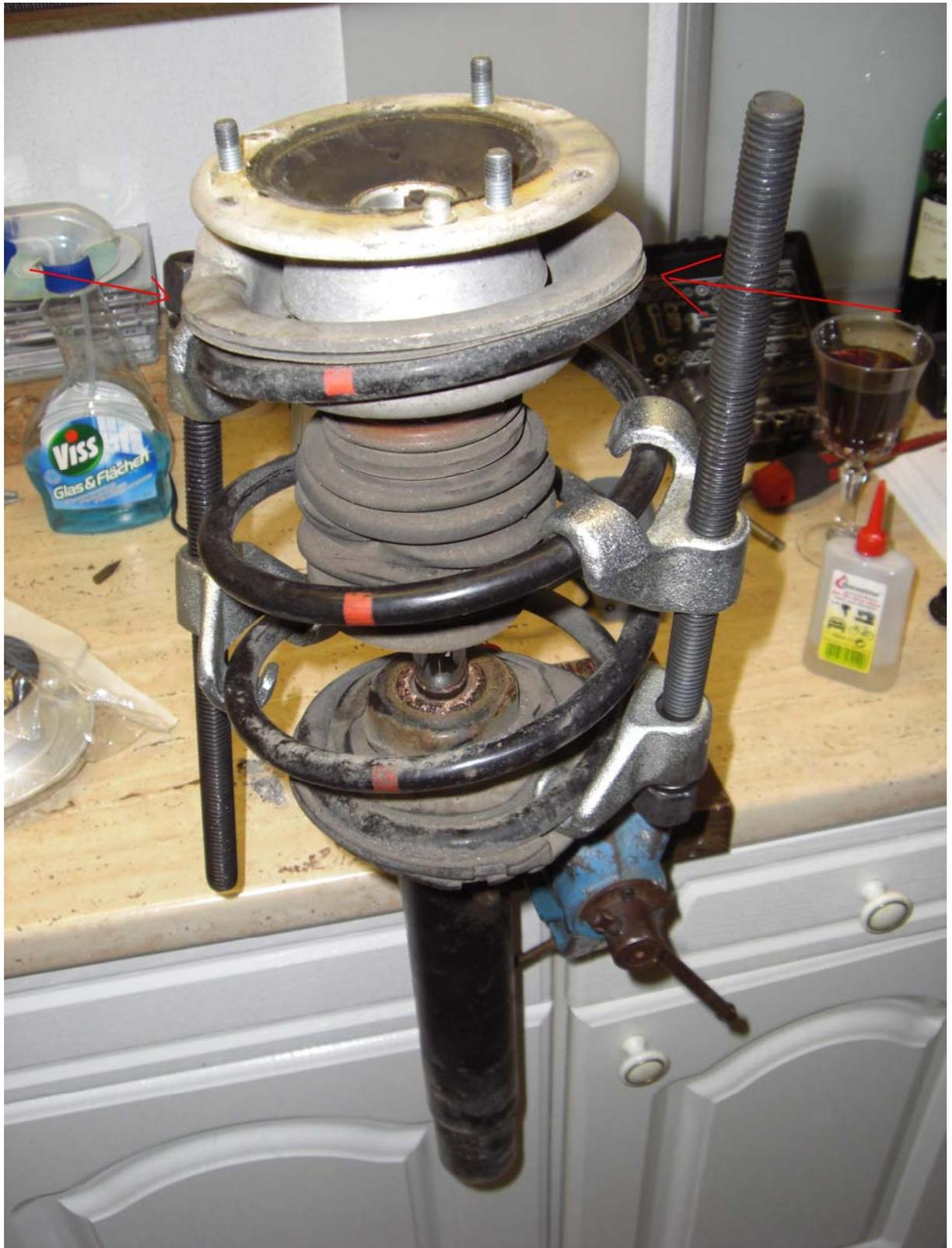
9. Wenn die Feder vernünftig vorgespannt ist, kann man sich an die obere Haltemutter des Dämpfers bzw. Stützlagers heran machen. Hierzu muss erstmal die Staubkappe abgehebelt werden.
