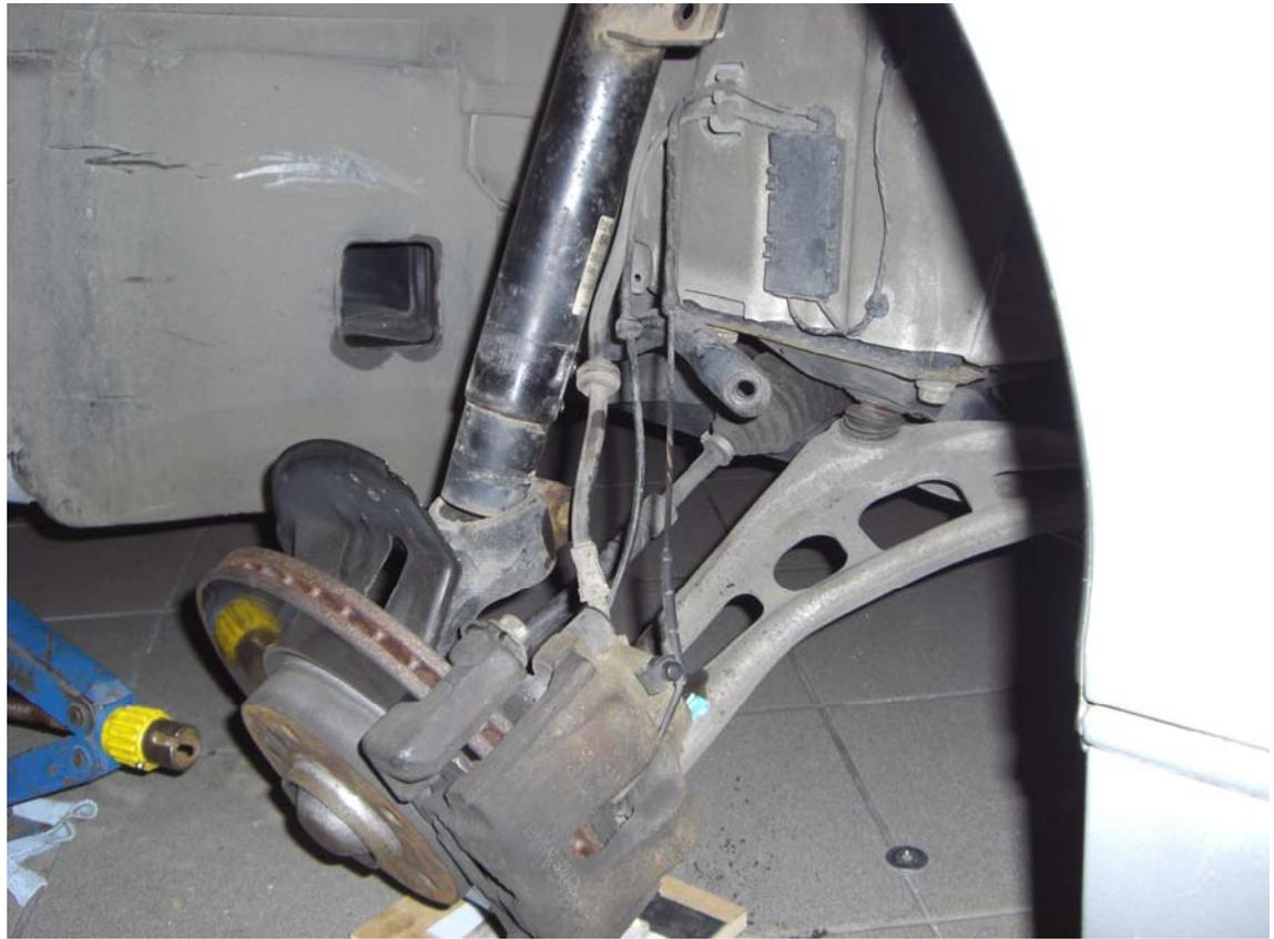
7. Nun kann man die **drei Muttern** am Dom lösen. Das Federbein kann dann komplett (mit Stützlager) aus dem Radhaus entnommen werden. Vorsicht beim lösen der Muttern, das Federbein kann herunter fallen!
