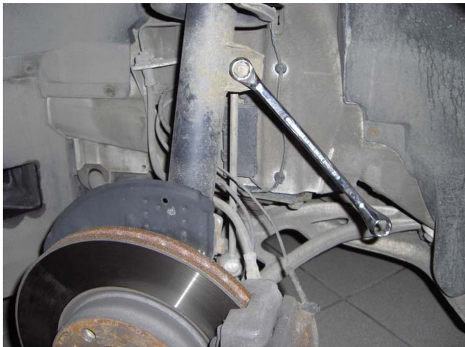
Wenn man die Koppelstangen nicht ab bekommt, dann muss man den Wagenheber richtig hoch leiern und den Achsträger mit einem zweiten Wagenheber und einem Holz abstützen und dann wieder herunter leiern. So verliert die Pendelstütze an Druck gegen den Stabilisator!
